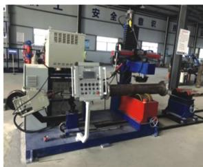
管道法兰自动焊接
