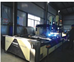
风管法兰自动焊接
