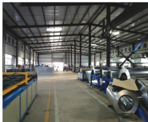
全自动风管预制生产线
