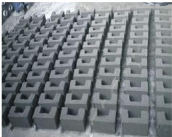
图11 单个开关插座U型预制块
