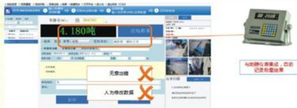
运用移动设备对钢结构构件的生产、运输、进场、安装、验收等环节进行智能化管理。通过扫码二维码，完成钢构件状态的更新，数据与BIM模型关联，及时准确的反应在平台，通过模型，实时更新提高了现场进度，提高了管理效率。
