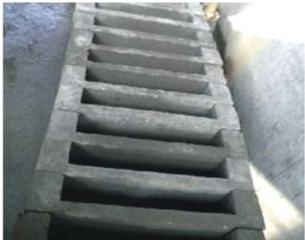
图9 多个开关插座U型预制块
