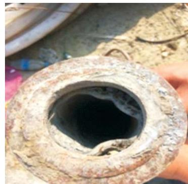
传统的喷浆管连接装置的内径与喷浆管的内径相同，喷浆管与连接装置不能保证完全贴合紧密。当竖井深度较大时，浆液流速较大冲击力大，当喷浆管一端有凸起时，喷浆管凸起部分受到浆液较大的冲击力，极易导致喷浆管的接头处软管翻起，随着浆液的输送，翻起会越来越严重，最后导致喷浆管破坏，导致工序时间延长及砼浪费等问题。
