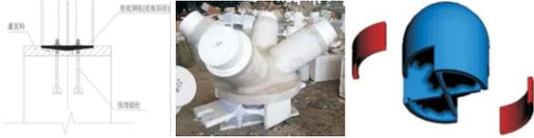
图11斜向面铸钢节点
