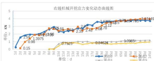
图5.5 右线机械开挖应力状态曲线图
