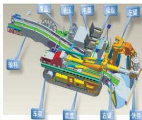
图4.2 主机整体结构
