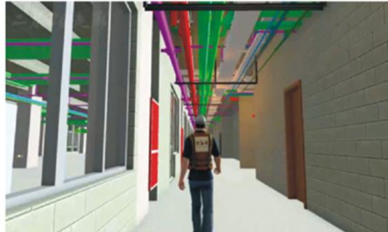
和对比个档案的可行性，最终确定最优方案，并根据最优方案指导现场实施，并以此来确定各专业管线合理的排布位置，避免各专业人员在安装过程中出现的碰撞冲突等，达到减少返工和材料损耗的效果。规定时间方案终审，将方案制定由“问答题”变为“选择题”，邀请设计、监理、业主参加方案比选会议，经过三天的会议，48栋单体机电管综方案多方签字一气呵成，不但为后期决算提供宝贵资料，同时为现场实施节省了大量的时间。
