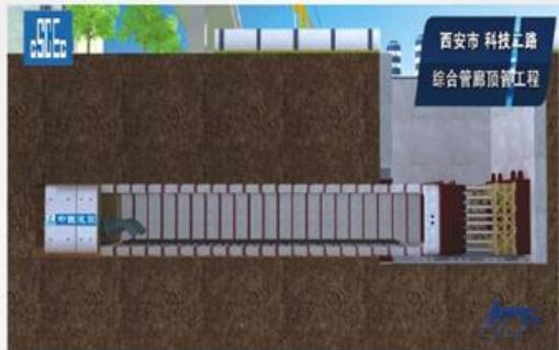
顶管施工示意图
