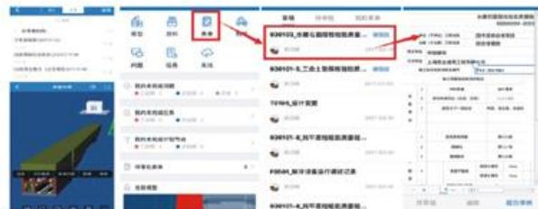
在整合深化过程中，确定各专业重要节点接口施工工艺工序及穿插要求，同时链接相关规范做法，利用移动端现场随时进行三维可视化模型交底、信息查
