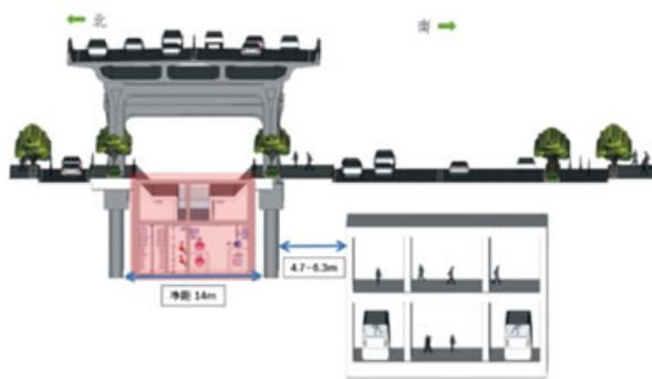
图3 管廊与地铁通道断面位置关系示意图
