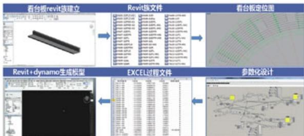
图21 看台板参数化设计流程
