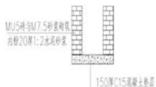
图2 基底集水井剖面图
