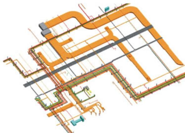
图6 密肋梁结构管线支吊架布置三维图
