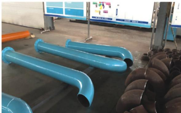
图1-4 管组单元化拼装+自有法兰盘与自然焊口分段实施图
