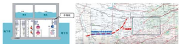
图24 水系包围下的综合管廊 图25 昆明路地下综合管廊穿越F3地裂缝
