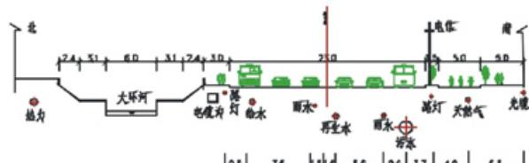
图2 七号桥以西城市管网布置
