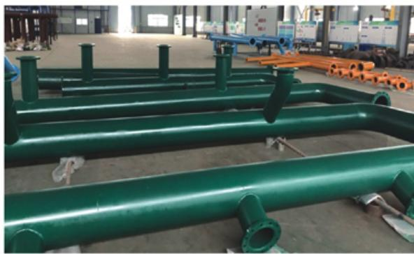
图1-3 管组单元化拼装+法兰盘分段实施图
